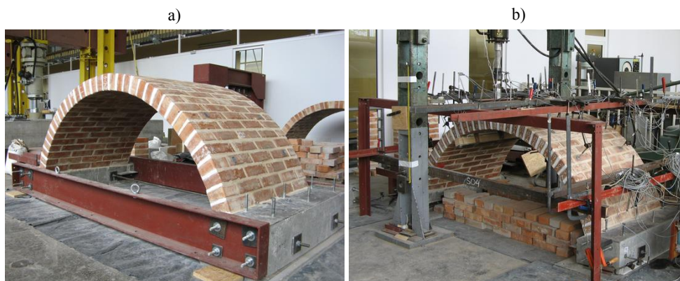
Rys. 9. Element S04: a) na stanowisku roboczym, b) przed badaniem, na stanowisku badawczym
