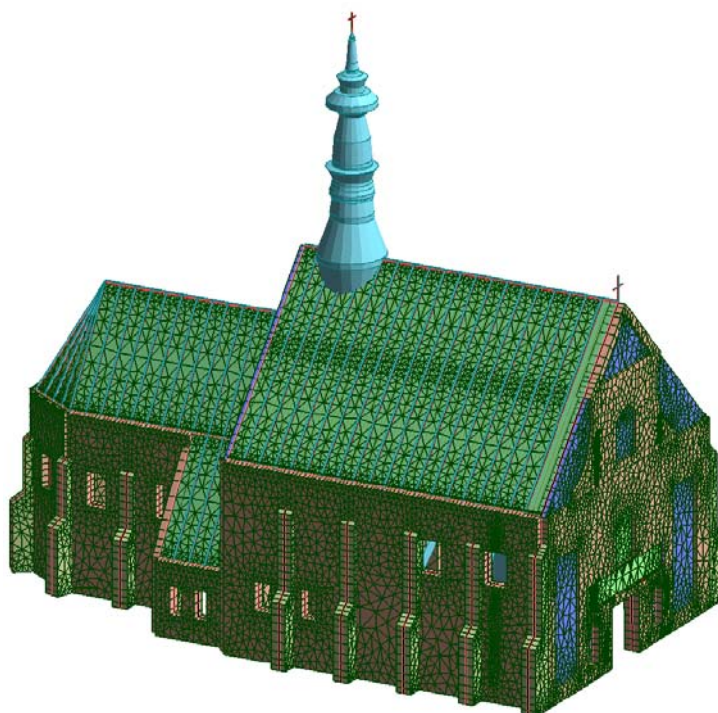
Rys. 2. Podział modelu obliczeniowego na elementy skończone
