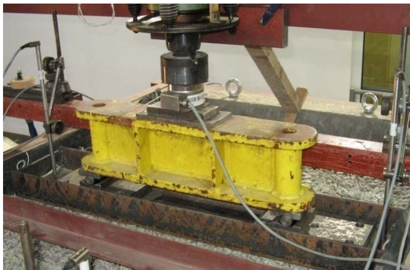
Rys. 4. Sposób przykładania obciążenia do sklepienia z zasypką
