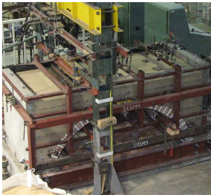
Rys. 13. Sklepienia z zasypką z piasku przed badaniem
