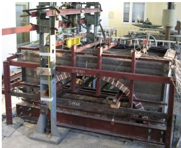
Rys. 8. Widok elementu z zasypką z keramzytu przed badaniem
