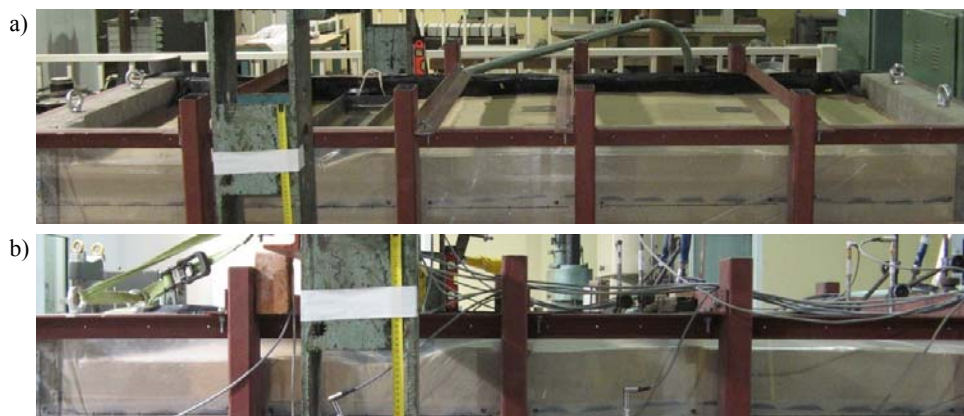
Rys. 15. Widok zdeformowanej powierzchni zasypki: a) widok powierzchni górnej, b) widok z boku
