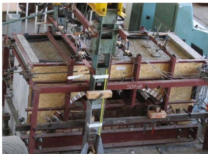
Rys. 10. Widok sklepienia z zasypką z granitu przygotowanego do badania
