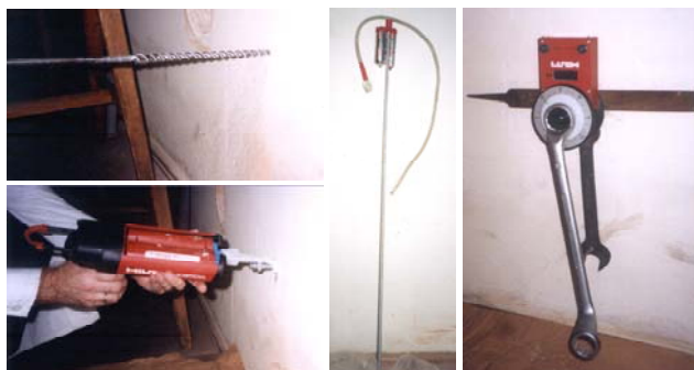
Rys. 3. Montaż i obciążenie próbne kotwy wklejanej na żywicy epoksydowej HIT RE500 (1998 r.)
