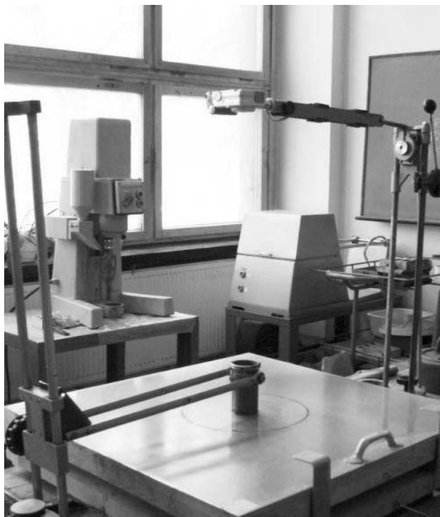
Fot. 1. Płyta do rozplywu zaczynu Photo 1. Slab for slump flow of cement paste
