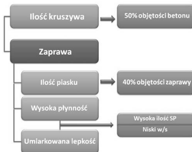
Rys. 1. Schemat projektowania BSZ wg metody japońskiej w schemacie zaprawa–mieszanka [4, 5]
