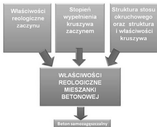
Rys. 2. Główne czynniki decydujące o właściwościach reologicznych mieszanki wg [6–8]
