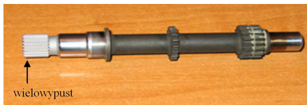
Rys. 6. Wielowypust wykonywany opisywanym nożem Fellowsa na części typu „wałek”
