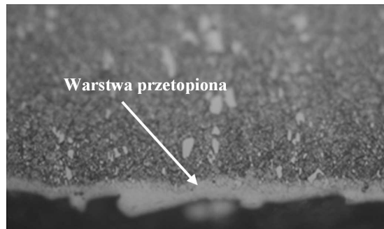
Rys. 8. Mikrostruktura stali VANADIS 60 z widoczną na powierzchni cięcia warstwą przetopioną, powiększenie 500 X
