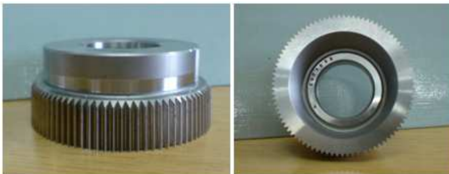
Rys. 3. Dłutak modułowy z ostrzami wykonanymi metodą elektroiskrowego cięcia: widok na powierzchnię natarcia (na lewo), widok z boku (na prawo)
