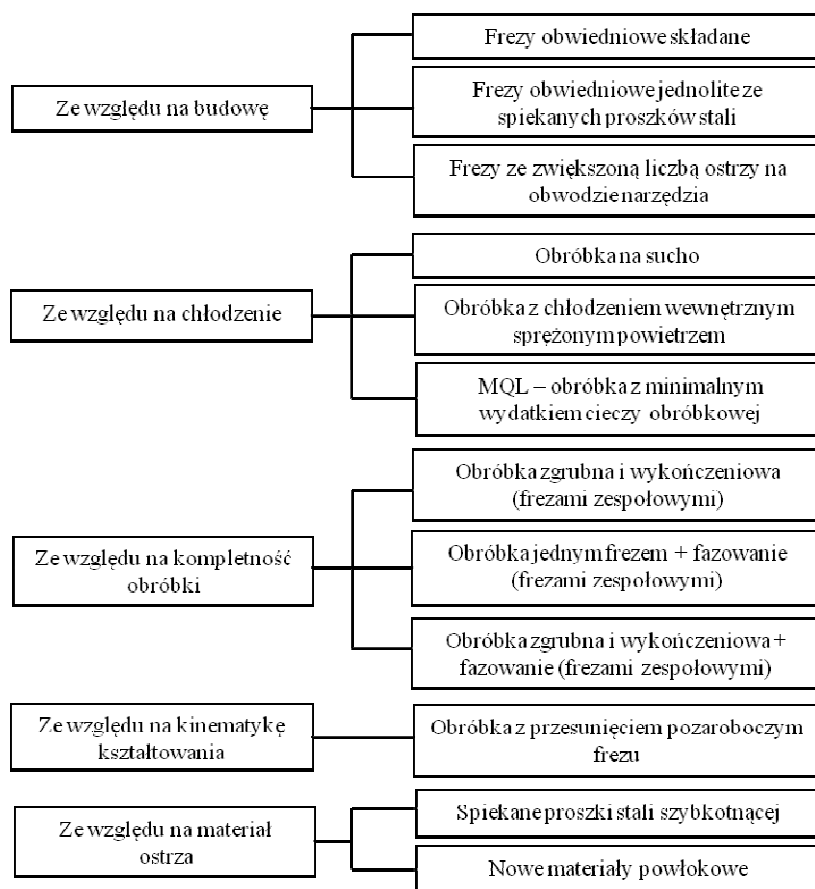
Rys. 1. Trendy w konstrukcji narzędzi do uzębień walcowych
