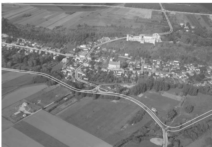
Rys. 6b. Studium przebiegu drogi obwodnicowej, Janowiec. Szkic wizualizacji na podkładzie zdjęcia z motolotni. Fot. M. Olszówka. Widoczne południowe tereny nieużytków i substandardowych upraw na terenach zalewowych. Źródło: Kosiński W., Byrski P., 2007 A.
