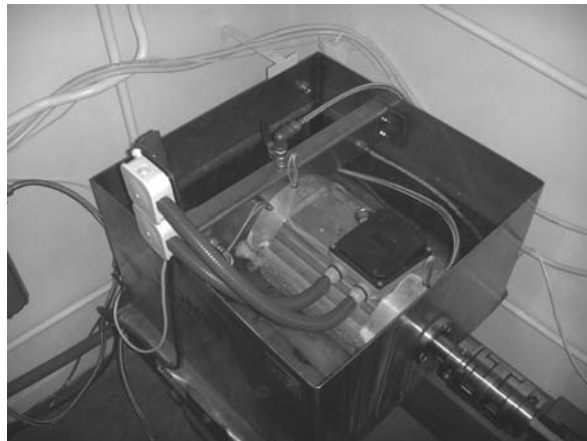
Fig. 9. Laboratory model of a PM generator working in water Rys. 9. Laboracyjny model generatora z magnesami trwałymi pracującego w wodzie
