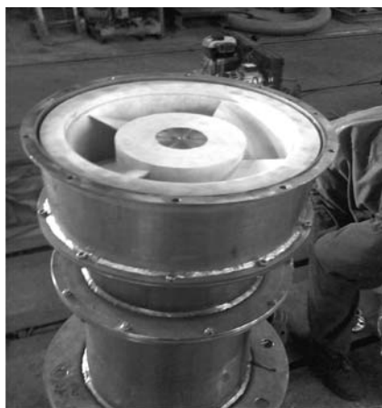
Fig. 7. Assembly of the turbine model Rys. 7. Model turbiny po złożeniu
