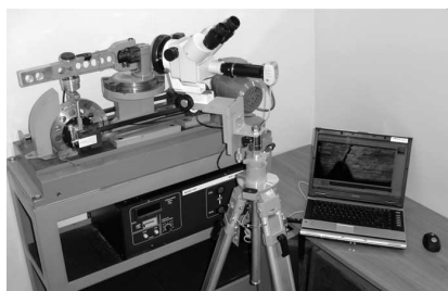
Fot. 1. a) zdjęcie maszyny zmęczeniowej MZGS 100; b) schemat obciążenia próbki Photo 1. a) fatigue test stand MZGS 100; b) specimen loading
