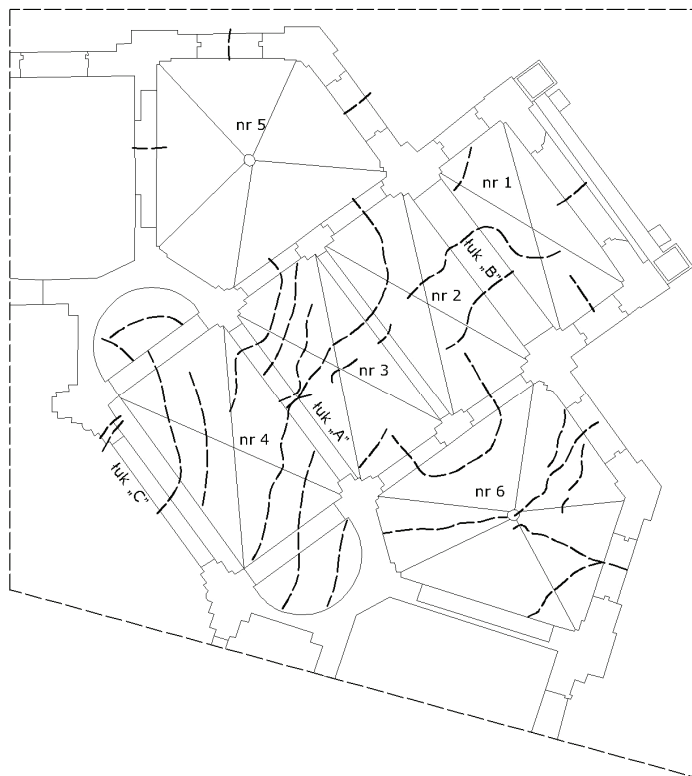
Rys. 2. Rzut sklepień z rysami i pęknięciami (linie przerywane) Fig. 2. Sketch of vaults with scratches and splits (discontinuous line)
