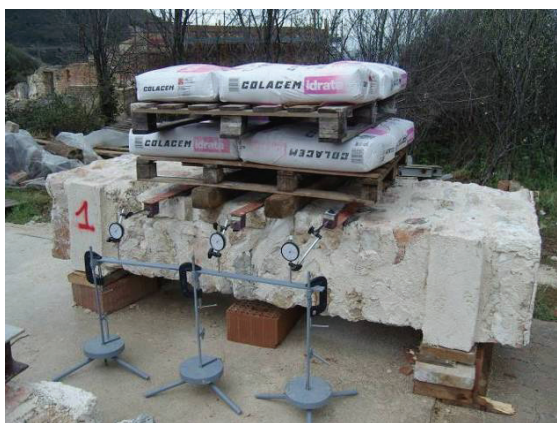
Fig. 7. Panel 1, placed horizontally, on two supports Rys. 7. Płyta 1 ułożona poziomo na dwóch podporach
