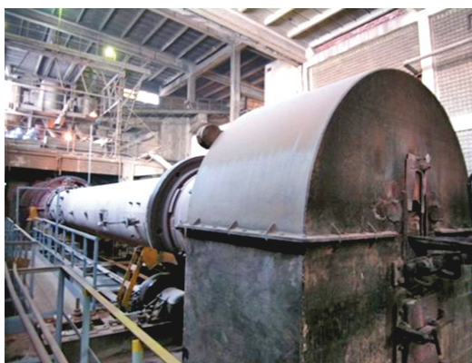
Rys. 4. „Duży” piec do wypalania klinkieru rzymskiego (w hali produkcyjnej OMMB)
