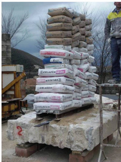
Fig. 9. Testing of panel 2 Rys. 9. Próba zginania płyty 2
