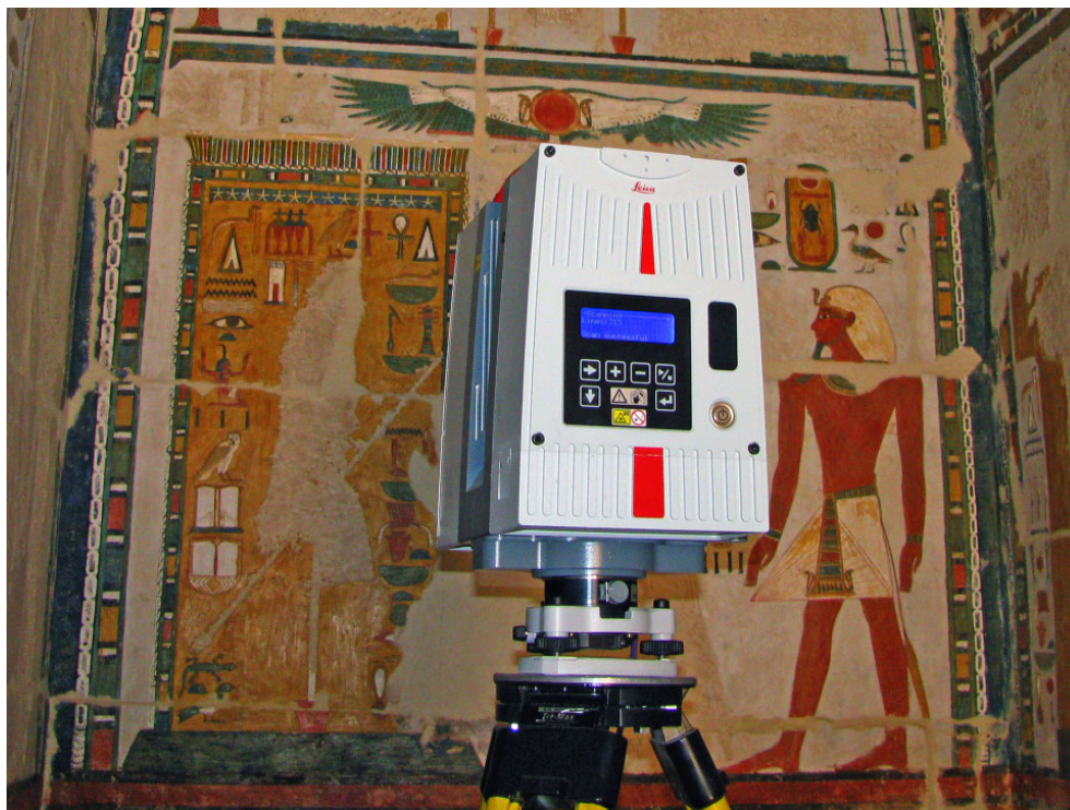
Rys. 1. Skaner Leica HDS 6000 ustawiony na spodarcie Fig. 1. Leica HDS 6000 scanner mounted on tribrach
