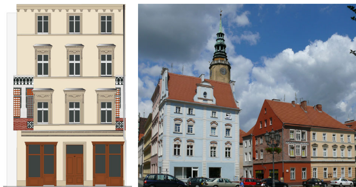
Rys. 14. Propozycja ekspozycji gotyckich fragmentów w elewacji kamienicy przy ul. Dzierżonia 10 (projekt J. Skarbek) oraz widok na blok śródrzynekowy ze wschodnią i południową elewacją sukienic po pracach konserwatorskich (foto. A. Peszko) Fig. 14. Suggestion of displaying the Gothic fragments in the elevation of the tenement house at 10 Dzierżonia St. (designed by J. Skarbek) and a view of the central market block with the eastern and southern elevation of the cloth hall after conservation work (Photo.: A. Peszko)
