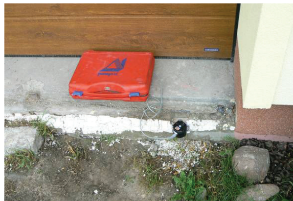
Rys.8. Czujnik zamocowany do ławy żelbetowej Fig. 8. Geophone location
