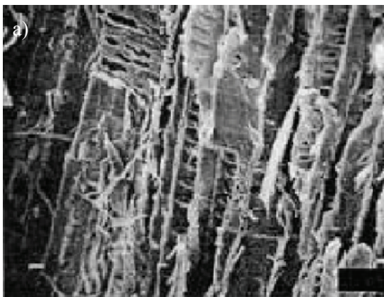
Rys. 1. Fotografie pod mikroskopem drewna sosnowego[3]: a) przed obróbką termiczną, b) po obróbce termicznej Fig. 1. Photomicrograph of pinewood [3]: a) before heat treatment, b) after heat treatment
