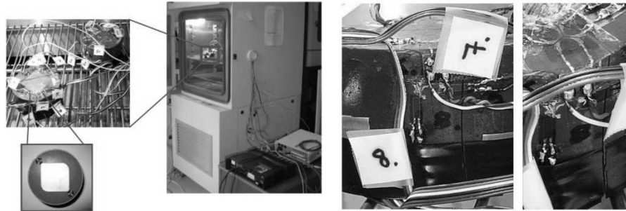
Rys. 6. Komora klimatyczna oraz próbki z widocznymi pęknięciami
