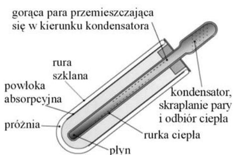
Rys. 6. Kolektor z rurką ciepła
