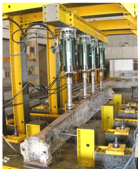
Rys. 8. Stanowisko badawcze w Laboratorium Badawczym Materiałów i Konstrukcji Budowlanych Katedry Budownictwa Betonowego Politechniki Łódzkiej
