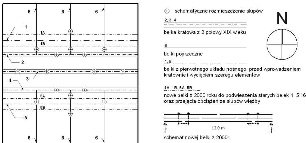
Rys. 7. Schemat wzmocnienia konstrukcji nośnej więźby wieży.
