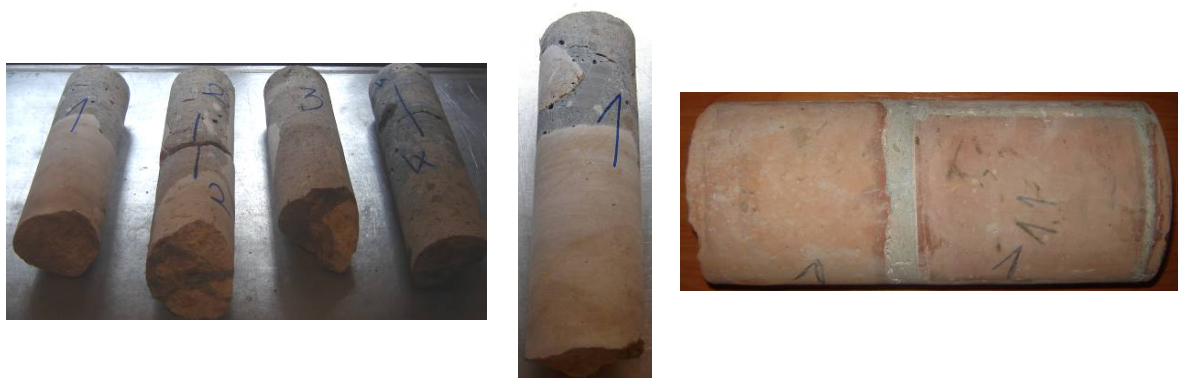
Rys. 1. Odwierty rdzeniowe wycięte z konstrukcji murowych w celu określenia wytrzymałości, wilgotności i stopnia zasolenia.
