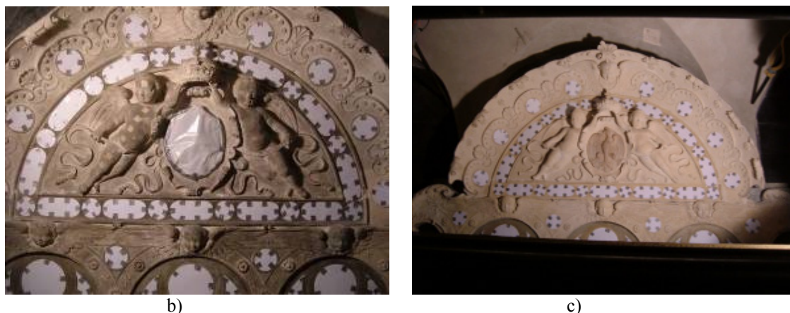
Rys. 2. Ściana tronowa w Kaplicy Batorego na Wawelu w trakcie testów: Fot. J. Marczak. a), b) przed oczyszczaniem c) po procesie oczyszczania promieniowaniem laserowym
