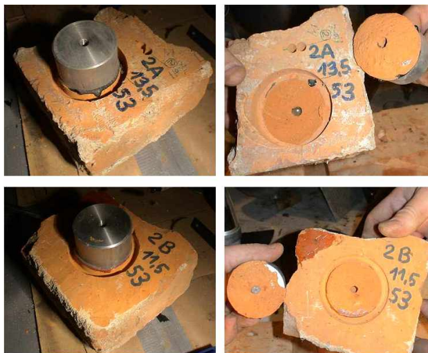
Rys. 3. Próbkę 2/A z podatną i 2/B ze sztywną warstwą adhezyjną przed i po zerwaniu [8] Fig. 3. Specimens 2/A with flexible and 2/B with stiff adhesive layer, before and after damage [8]
