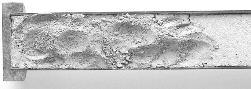
Rys. 5. Zniszczona próbka iltu illitowego nasyconego benzyną po badaniu skurczu liniowego
