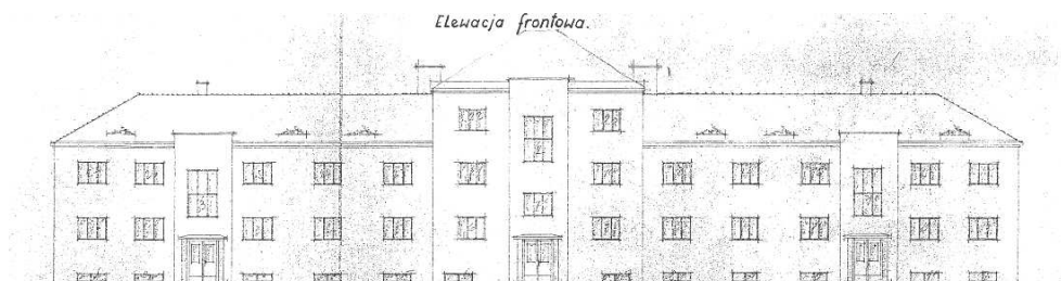
Rys. 7. Projekt budynku mieszkalnego dla Fabryki Celulozy w Niedomicach, 1948 r., E. Czyż. Na elewacji frontowej wrysowano ołówkiem dach czterospadowy wysoki i z takim kształtem dachu budynek zrealizowano w latach 1949–1950. Widoczna ingerencja w warsztat architekta, prawdopodobnie Urzędu Woj. w Krakowie, zapowiedź nadchodzącego kierunku w sztuce i architekturze – realizmu socjalistycznego
