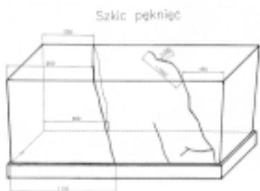
Ryc. 2. Lokalizacja spękań ścian sarkofagu (wyk. ZD-PROJEKT) Fig. 2. Locating the cracks in the sarcophagus walls (made by ZD-PROJEKT)
