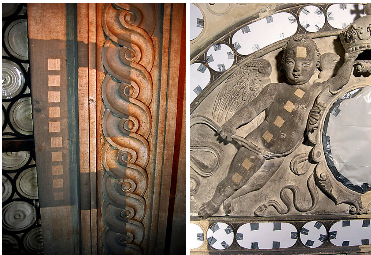
Rys. 1. Testy oczyszczania laserem pilastra w latarni Kaplicy Zygmuntowskiej oraz aniołka na ścianie tronowej w Kaplicy Batorego na Wawelu. Fot. J. Marczak
