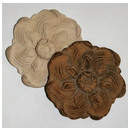
Rys. 6. Rozety wykonane z cementu romańskiego. Różnicowanie kolorystyczne zależy przede wszystkim od składu chemicznego materiału oraz od warunków jego wypału
