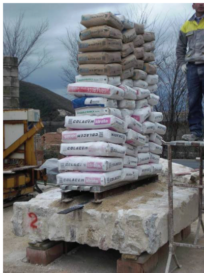
Fig. 9. Testing of panel 2 Rys. 9. Próba zginania płyty 2
