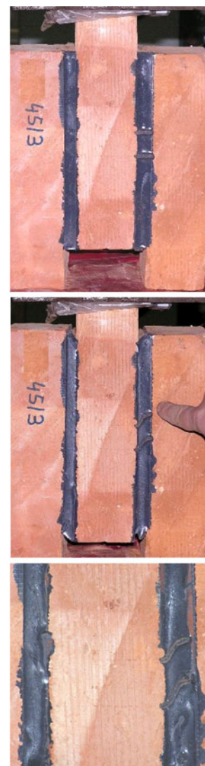
Rys. 8. Krzywe siła-przemieszczenie otrzymane podczas ścinania cegieł połączonych zaprawą (M) i polimerem (pm45) oraz widok testowanej próbki (postać zniszczenia) Fig. 8. Force-displacement curves obtained during shear tests of bricks joined with mortar (M) and with polymer (pm45) and also view of testing specimen (form of damage)
