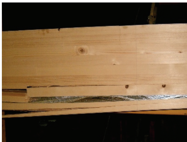
Rys. 5. Przykładowe obrazy zniszczenia belek wzmocnionych Fig. 5. Exemplary modes of failure of strengthened beams
