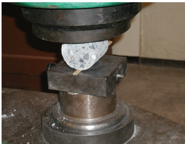
Rys. 6. Próba rozłupywania Fig. 6. Split test
