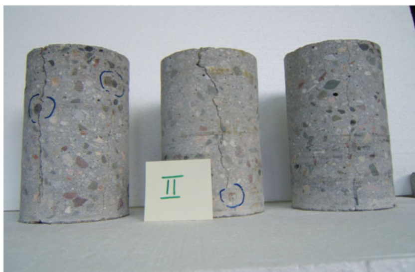
Rys. 6. Odwierty ze stropu – widoczny przebieg rys na grubości płyty stropowej Fig. 6. Test elements from floor – cracks on the depth of floor
