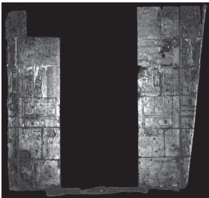
Rys. 10. Ortofotomapa jednej ze ścian świątyni użyty jako dokument referencyjny przy generowaniu fotomozaiki Fig. 10. Orthophoto image of one of temple walls used as reference for photomosaic production
