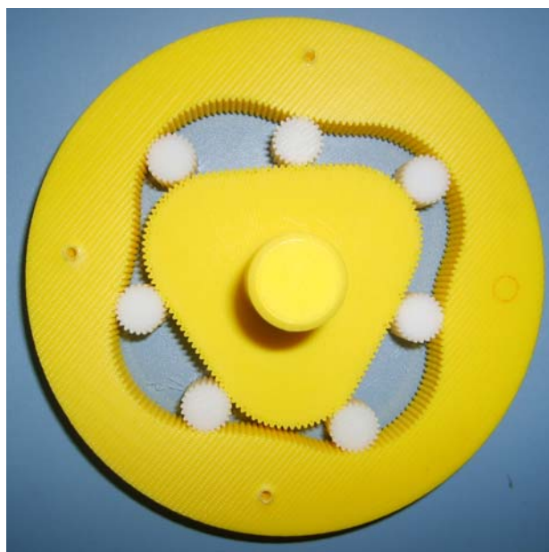
Fig. 6. Model of cam planet gear motor manufactured by Rapid Prototyping method Rys. 6. Model silnika obiegowo-krzywkowego wykonany metodą Rapid Prototyping
