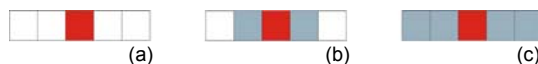
Rys. 2. Rodzaje sąsiedztwa w zagadnieniach jednowymiarowych: (a) – puste, (b) – Moore'a, (c) – rozszerzone Moore'a
