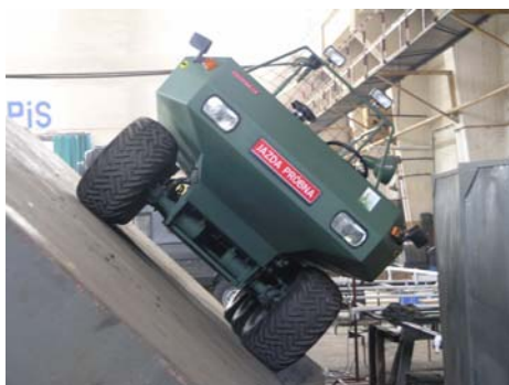
Rys. 5. Pomiar max kąta statycznego przechylenia bocznego
