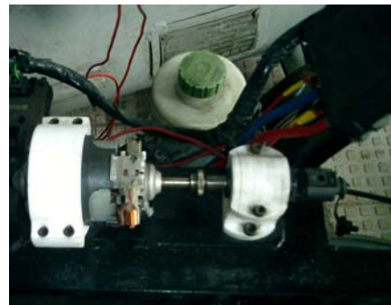
Rys. 2. Stanowisko pomiarowe służące do badania zestawu wskaźników: a) napęd obrotomierza, b) napęd prędkościomierza
