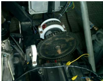
Rys. 2. Stanowisko pomiarowe służące do badania zestawu wskaźników: a) napęd obrotomierza, b) napęd prędkościomierza
