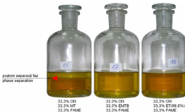
Rys. 3. Widok badanych mieszanin paliwowych przechowywanych w temperaturze 20°C
