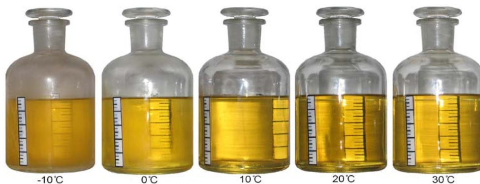
Rys. 4. Mieszanki ON:EMTB (50:50%, v/v) przechowywane w różnych temperaturach
