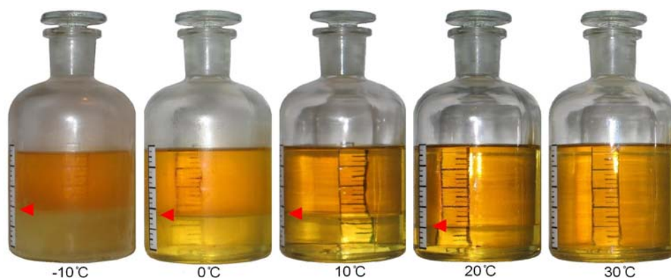
Rys. 5. Mieszaniny ON:ET (50:50%, v/v) przechowywane w różnych temperaturach
