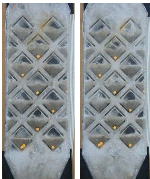
Rys. 6. Obraz przepływu w modelu reaktora Fig. 6. Images of flow on the model of the catalytic converter
