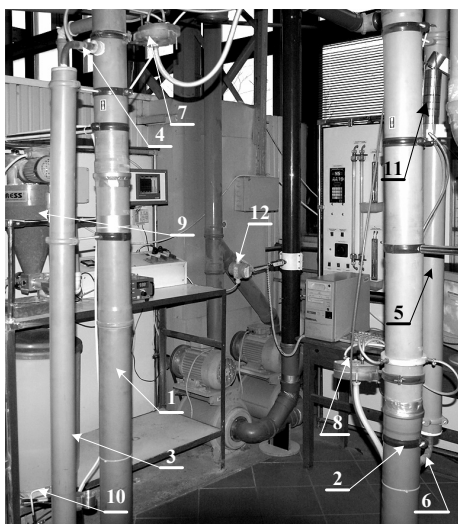
Rys. 3. Fragment stanowiska laboratoryjnego 1 – rurociąg wlotowy, 2 – rurociąg wylotowy, 3 – pomocniczy rurociąg pomiarowy na wlocie, 4 – sonda wlotowa pomocniczego odcinka pomiarowego, 5 – pomocniczy odcinek pomiarowy na wylocie, 6 – sonda wlotowa, 7 – układ pomiaru stężenia cząstek na wlocie, 8 – układ pomiaru stężenia cząstek na wylocie, 9 – sterowany dozownik cząstek, 10 – impaktor na wlocie, 11 – impaktor na wylocie, 12 – czujnik pomiaru natężenia przepływu strumienia aerozolu w stanowisku
