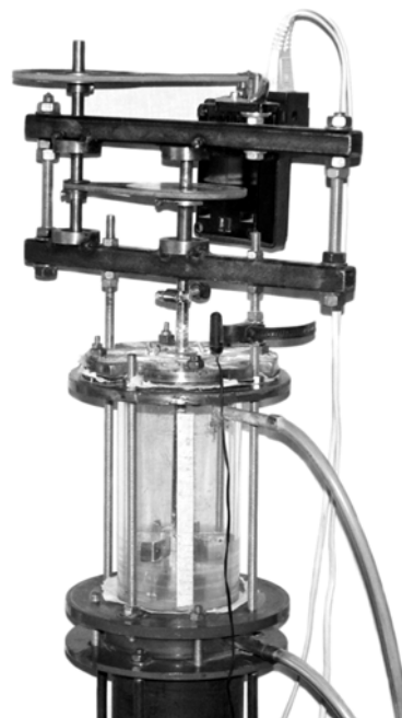
Rys. 1. Zdjęcie kolumny i mieszadła z napędem
