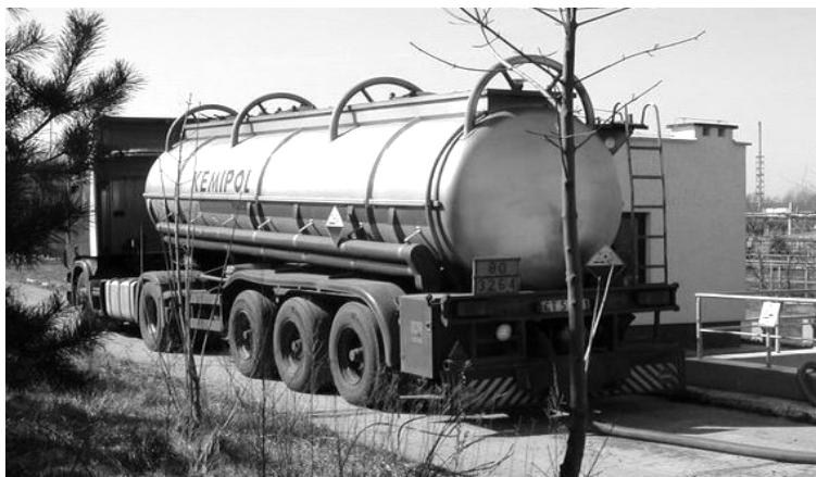
Fot. 1. Przykładowy wóz asenizacyjny służący do wywozu ścieków z terenów nieskanalizowanych [4]
