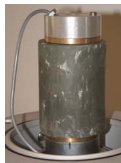
Rys. 4. Przygotowane do badań NNSy: a) gytia torfiasta, b) gytia detrytusowo-wapienna
