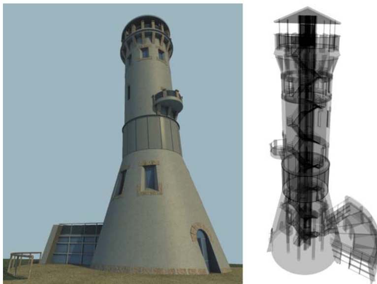
Ryc. 1. Widok pld.-zach. projektowanej wieży na Śnieżniku Kłodzkim oraz jej schemat funkcjonalny
