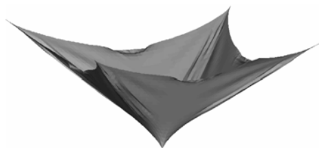
Ryc. 2. Wizualizacja otrzymanych własnych wyników dla symetrycznej płaskiej membrany obciążonej siłą skupioną
