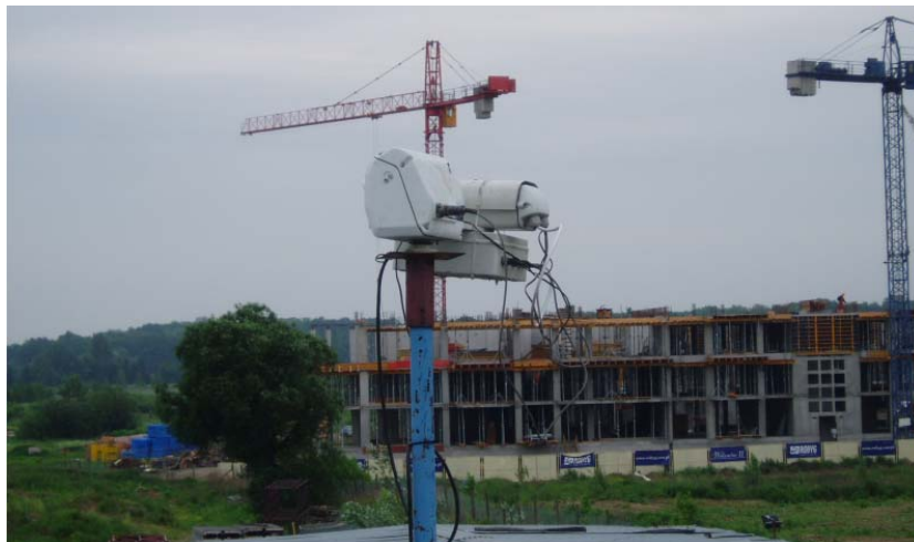
Ryc. 5. Kamera (analogowa) podsystemu ZOW wraz z obrotnicą, zainstalowana do monitorowania przebiegu budowy
