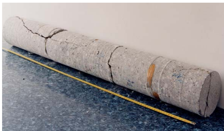
Ryc. 1. Odwiert z fundamentu wykonanego z betonu spełniającego wszystkie wymagania normowe.
