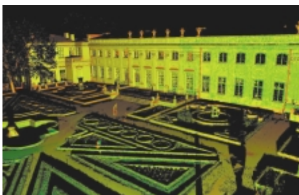
10. Ogród Wilanowski, przykład inwentaryzacji za pomocą laserowego skanera 3D. Wyk. K. Czajkowski
