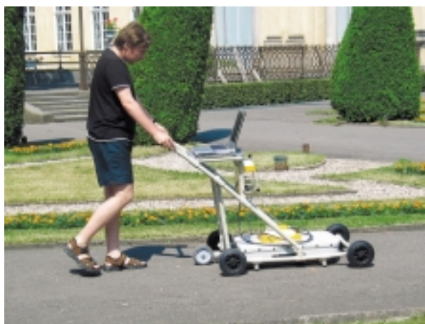
13. Ogród Wilanowski, badania za pomocą georadaru. Fot. A. Gołębniak
