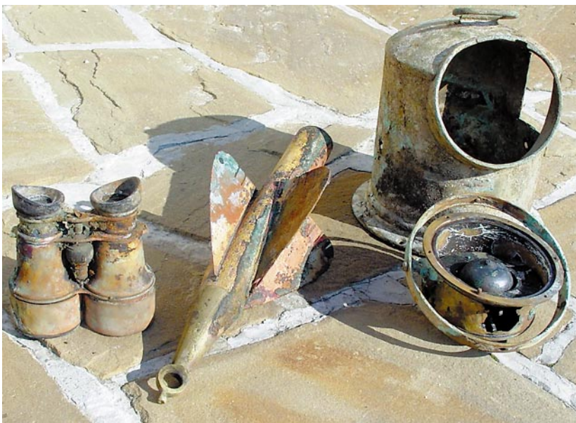
Fot. 5. Przedmioty z wraku „Christiny”: lornetka, log do pomiaru prędkości statku i żyrokompas
