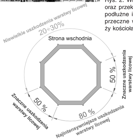
Rys. 3. Procentowy stopień uszkodzeń warstwy licowej hełmu wieży
