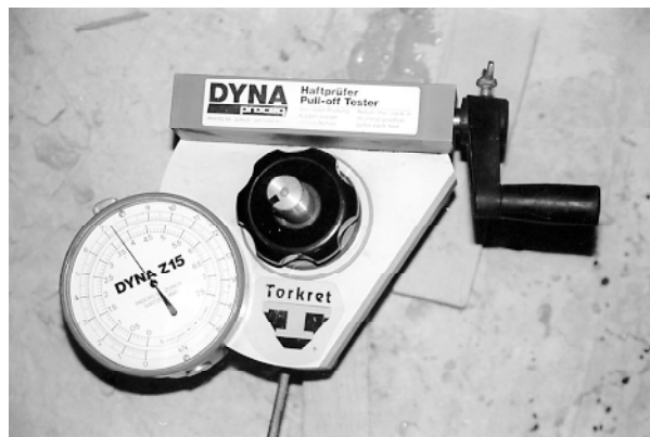
Fot. 17. Próba nośności kotwy na wrywanie. Zarejestrowana siła 7,4 kN
