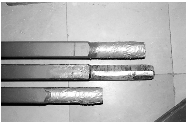
Fot. 7. Styki montażowe i końcówki ściągów
