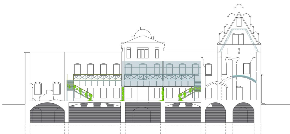
Rys. 3. Widok galerii, tymczasowego zadaszzenia oraz piwnic pałacowych
