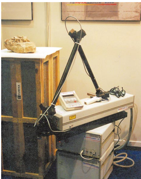
Urządzenie laserowe stosowane do czyszczenia powierzchni dekoracji kamiennej w kaplicy Zygmuntowskiej
