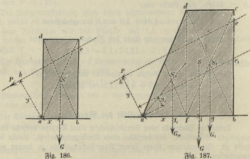
entgegen geneigt ist, so ist natürlich die Stabilität der Mauer eine größere, als beim rechteckigen Querschnitt. Je größer nämlich  $G$  und  $x$  wird, je größer kann auch  $P$  und  $y$  sein. Wird der Angriffspunkt der Kraft  $P$  mehr nach der Unterstüßungsfläche  $ab$  zu, von  $e$  nach  $e_1$  verlegt, so wird  $y$  kleiner  $= y_1$ , und kann demnach  $P$  desto größer sein.
