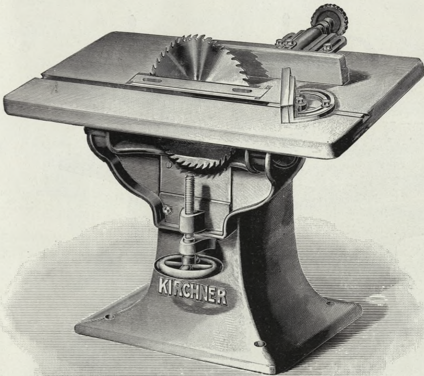
„Lidibur“. LWB. Ausführung wie LWA, Tisch aber auch schräg stellbar.
