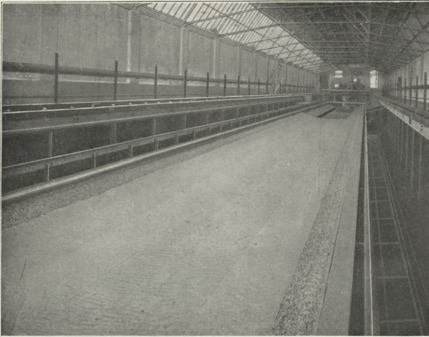
Fig. 82. Einwirkung der Einschraubenschiffe mit Heckabdeckung und 2 Rudern auf die Sohle des Modells des Rhein-Weser-Kanals nach 4000 Fahrten.
