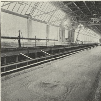
Einwirkung der Dampfer auf die Sohle des Modells des Rhein-Weser-Kanalmodells durch Arbeit am Ort (Versuchsdauer 1 st).
