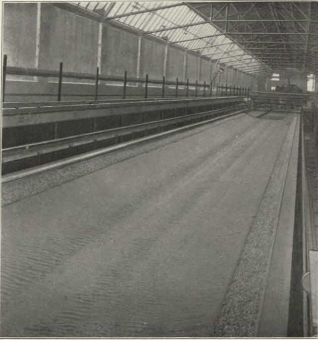
Fig. 78. Einwirkung der Einschraubenschiffe mit Heckabdeckung und 1 Ruder auf die Sohle des Modells des Rhein-Weser-Kanals nach 4000 Fahrten.
