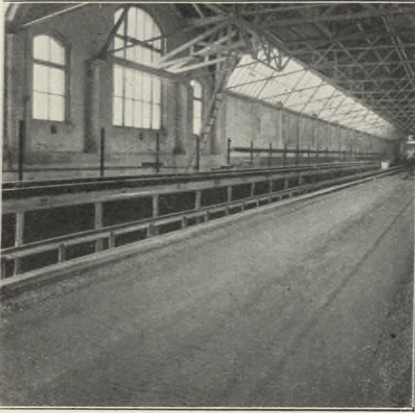
Einwirkung der Einschraubenschiffe mit Heckabdeckung und 2 Rudern auf die Sohle des Modells des Rhein-Weser-Kanals nach 400 Fahrten 0,53 (5,3) m seitlich der Mitte. Fig. 88. Ohne Sohlenabdeckung. Fig. 89. Mit teilweiser Sohlenabdeckung.
