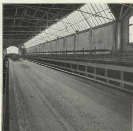
Fig. 86. Angriff der Einschraubenschiffe mit Heckabdeckung und 2 Rudern auf die Sohle des Modells des Rhein-Weser-Kanals nach 400 Fahrten.
