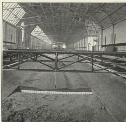
Einwirkung der Schraube auf die mit Kies bedeckte Sohle des Modells des Großschiffahrtsweges Berlin-Stettin nach 3510 Fahrten bei 808 Uml./min der Schraube. Kies von 1,75 bis 2,65 mm Korngröße. Fig. 60. Bedeckungstiefe 15 mm.
